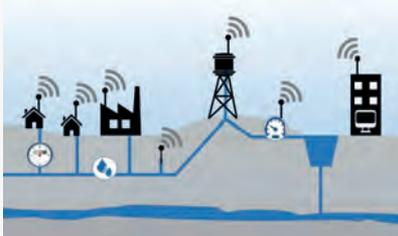
L'approche *Smart Networks* combine surveillance permanente et pilotage à distance des installations (SCADA), comptage intelligent et gestion du patrimoine. Le suivi des volumes produits (via GSM/GPRS) et consommés (via radio, systèmes mobiles et fixes, AMR/AMI), ainsi que la détection et la localisation des fuites en temps réel,
